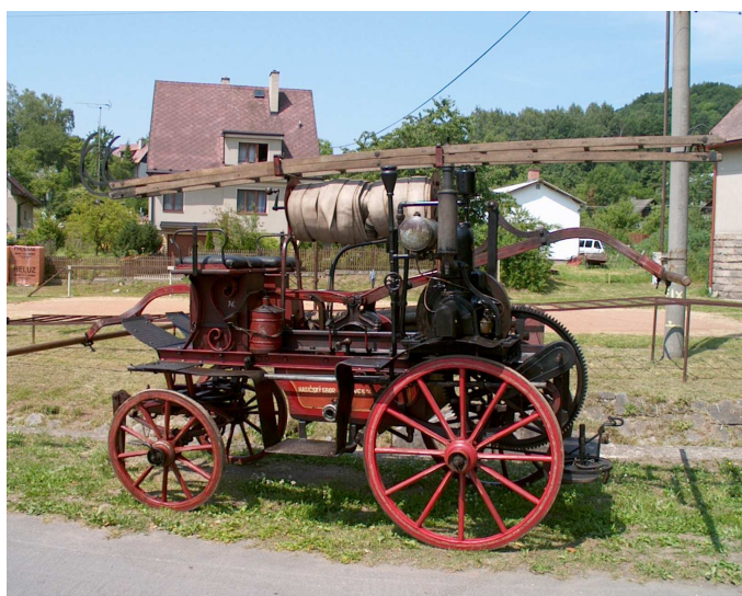
Na ruční čtyřkolovou stříkačku si v Nové Vsi instalovali stabilní motor
